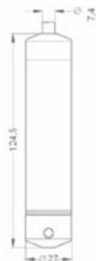
**Sensor de nivel sumergido piezorresistivo de alta calidad con membrana de acero inoxidable para la medición del nivel de agua potable.**
